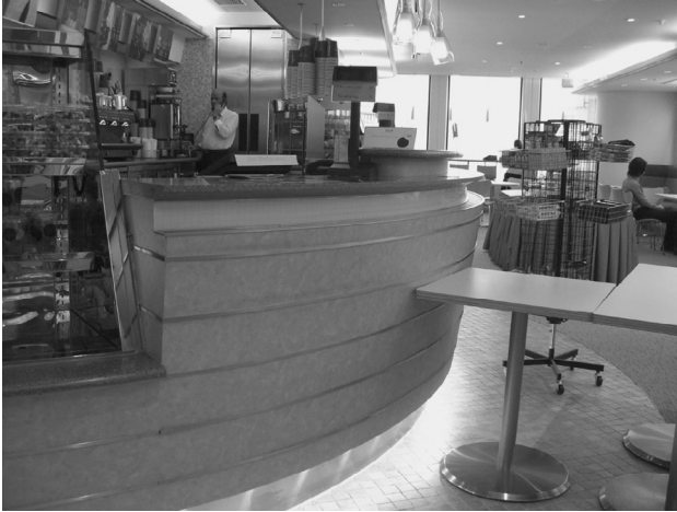
カウンターが高く、かつ奥行きが少ないため、 車椅子使用者が使用しにくい
