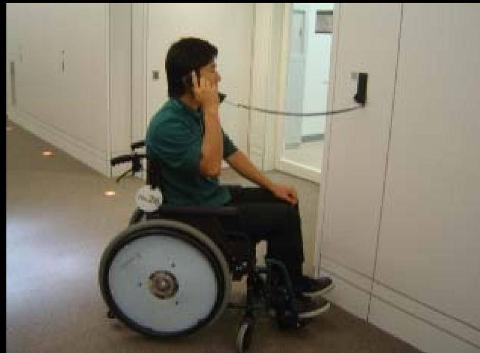
社内連絡用壁掛け電話は、片手でも取り扱いの簡易な小型の物に機種を変更し、高さも1450mmから1200mmに変更した。(六本木オフィス)
