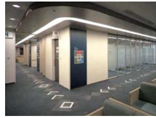
下がり天井とライン照明、床のデザインによる明かなメイン通路
